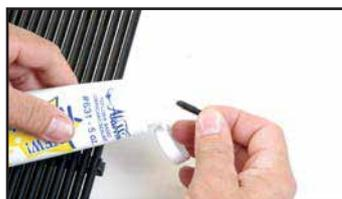
Lubrifier le bouchon et le trou dans le collecteur à l'aide d'un spray au silicones ou de Magic Lube
