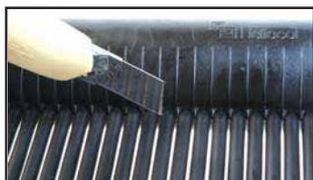
Couper le tube endommagé au ras du tuyau collecteur en évitant soigneusement d'endommager les tubes adjacents.
