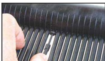
Introduire la pointe d'un insert dans le trou du bouchon et l'enfoncer jusqu'en butée
